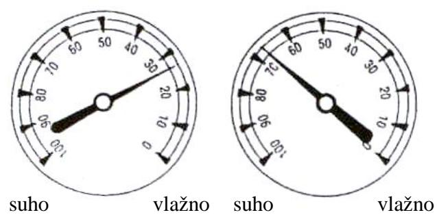
Ovakvo očitavanje znači da zemljište ima dovoljno vlage
