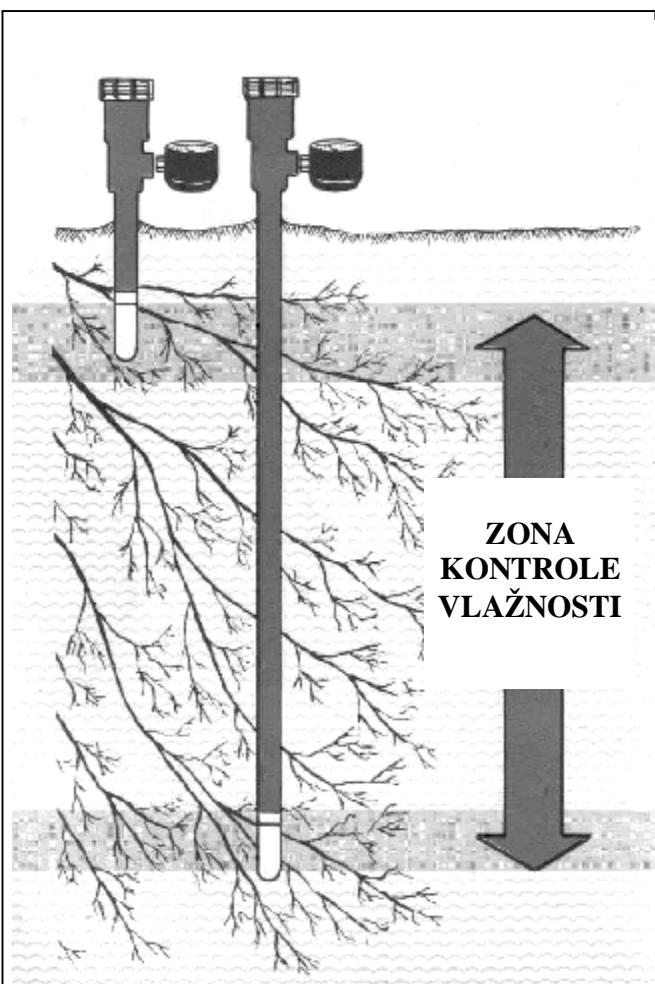
IRROMETER radi po principu tensiometara, koji je sasvim različit od ostalih sistema koji mjeri postotak vlažnosti. IRROMETER se sastoji od zatvorene cijevi napunjene vodom, specijalno vakumiranog brojčanika i poroznog vrha koji se postavlja u zemlju na željenu dubinu korijenove zone. Kod suhog zemljišta, voda biva izvučena iz instrumenta, smanjujući količinu vode u instrumentu i stvarajući vakum koji se onda očitava na brojčaniku. Što je zemljište više suho, to su veće vrijednosti.
